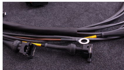
Använd krympslang med lim vid skarvning av kablar, samt använd skyddshylsor.
